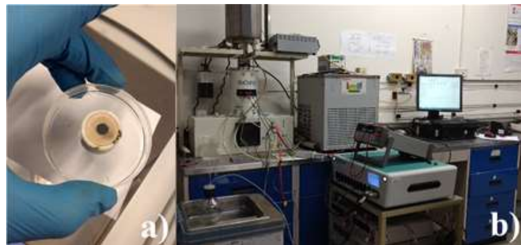
Figura 2. a) Celda fabricada SOFC, b) Equipo usado para el análisis de la SOFC.
