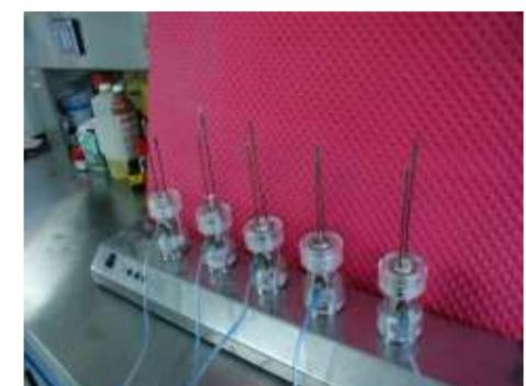
Figura 3. Serie de celdillas de digestión-lixiviación sobre un agitador múltiple, en operación.
