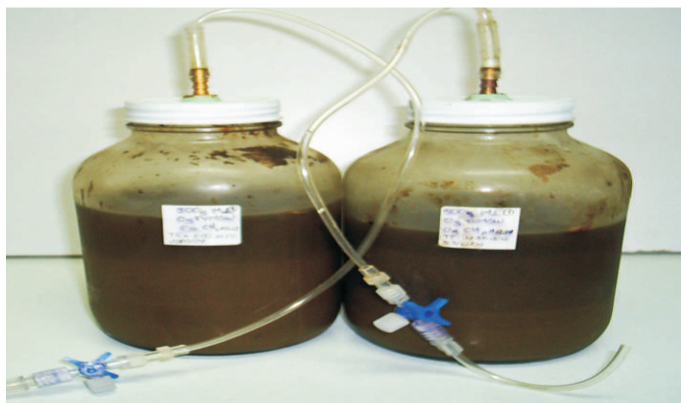
Fig. 1. Vista de los reactores utilizados para la producción de biohidrógeno.
