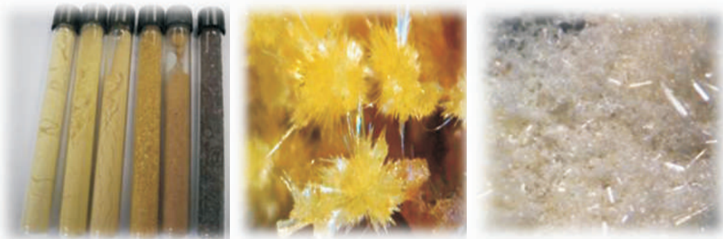
Fig. 3. Concentrados de ácido ferúlico obtenidos a partir de maíz y cristales del compuesto con diversos grados de pureza.
