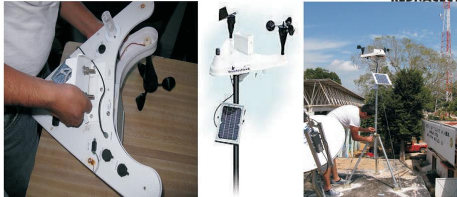
Fig 2. Estación meteorológica WeatherHawk y panel solar.
