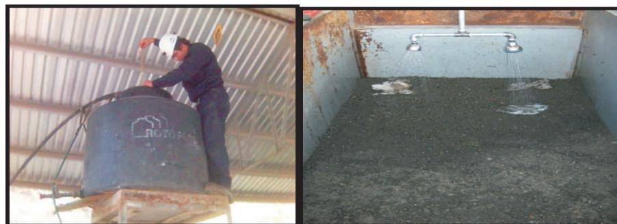
Fig 2. Suspensión microbiana (consorcio microbiano) (izq) y pileta de bioremediación escala piloto de suelos contaminados (der.).
