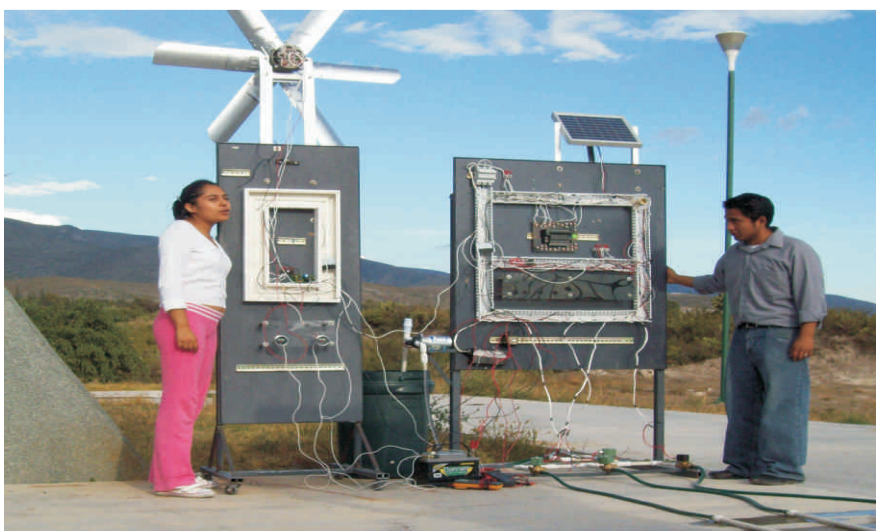
Fig. 1. Fig. 2 Prototipo de bombeo residencial o riego por aspersión en un invernadero.
