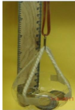
Fig. 2. Dinamómetro simple para experimentos de medición de fuerzas.
