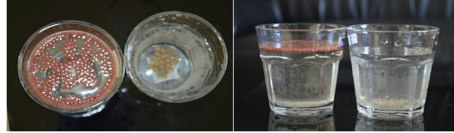
Figura 1. Alimentos extruidos con un equipo DP70 (extrusor de doble tornillo, Jinan Eagle Food Machinery, CO. LTD, Jinan China). En color rojo es alimento flotante y en color café alimento sedimentable.
