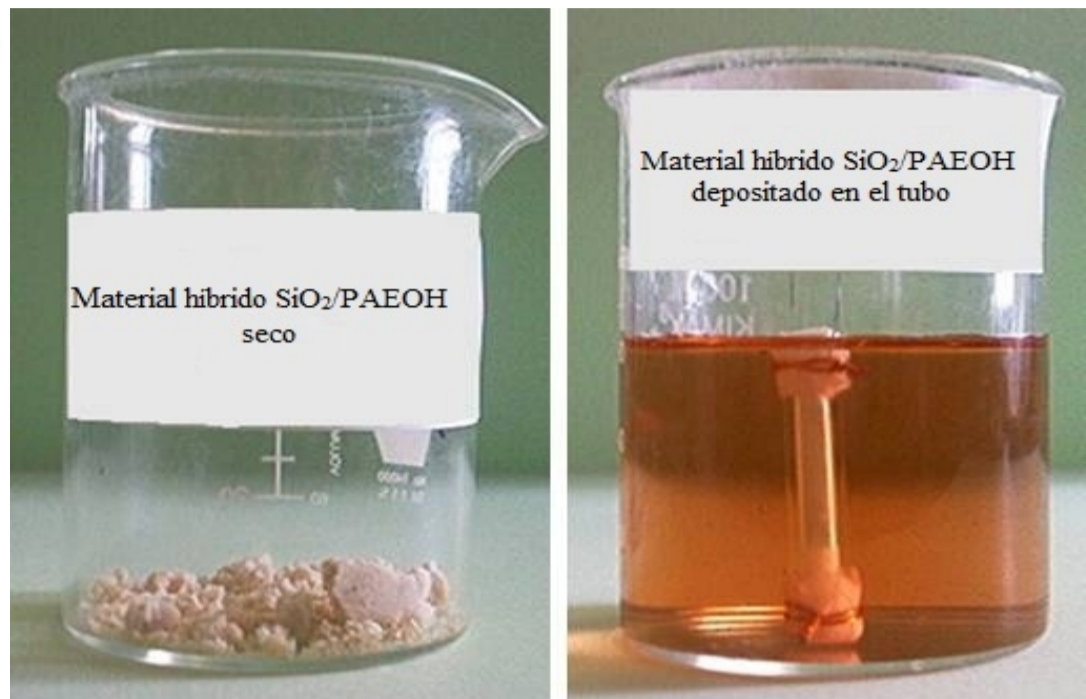
Figura 2. Material híbrido de \text{SiO}_2/\text{PAEOH} seco (imagen izquierda) y material híbrido \text{SiO}_2/\text{PAEOH} absorbiendo tolueno (imagen derecha).
