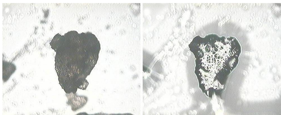
Figura 3. Micrografía del material híbrido \text{SiO}_2/\text{PAEOH} seco (imagen izquierda) y con tolueno absorbido (imagen derecha); con un acercamiento de 10 veces.
