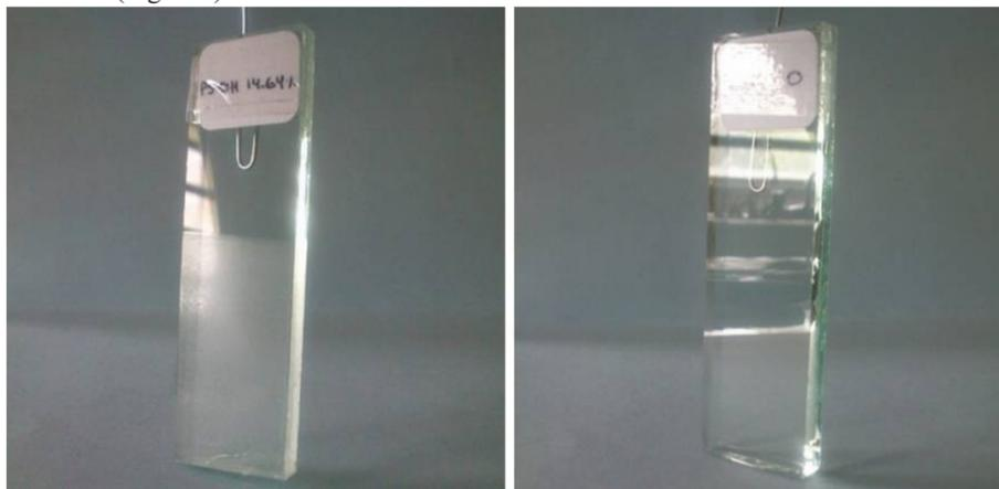
Figura 2. Sustrato de vidrio con recubrimiento de poliestireno/alúmina (PSOH/ $\alpha$ -Al<sub>2</sub>O<sub>3</sub>) (izquierda) y sin recubrimiento (derecha).
