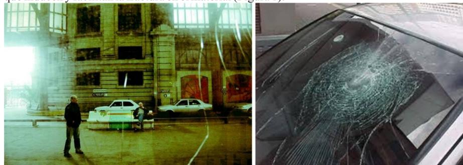
Figura 1. Fracturas típicas en ventanas de casa (izquierda) y parabrisas de automóvil (derecha).
