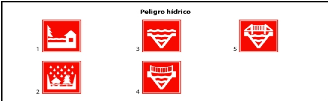
Figura 2. Peligro hídrico: 1) Encharcamiento; 2) Inundación por escorrentía; 3) Inundación desborde de río; 4) Destrucción puente colgante por aumento del nivel del río; 5) Destrucción puente vehicular por río.
