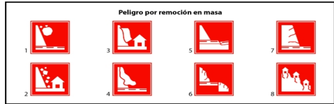
Figura 4. Peligro remoción en masa:- 1) Caída de rocas en carretera; 2) Caída de rocas en unidad zona habitacional; 3) Deslizamiento en zona habitacional; 4) Flujo de lodo en carretera; 5) Hundimiento en carretera; 6) Inestabilidad de talud y hundimiento en vía de comunicación.
