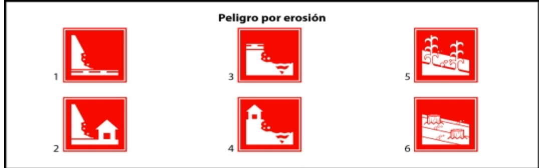
Figura 3. Peligro por erosión: 1) Erosión en carretera; 2) Erosión en zona habitacional; 3) Erosión de por flujo de río afecta carretera; 4) Erosión por flujo de río que afecta zona habitacional; 5) Erosión en zona de cultivo; 6) Erosión en zona deforestada.
