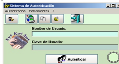
Figura 1. Ventana de autenticación del prototipo que se desarrolló, el cual autentifica a una persona de acuerdo a su forma de teclear.
