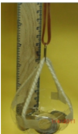
Figura 2. Dinamómetro simple para experimentos de medición de fuerzas.
