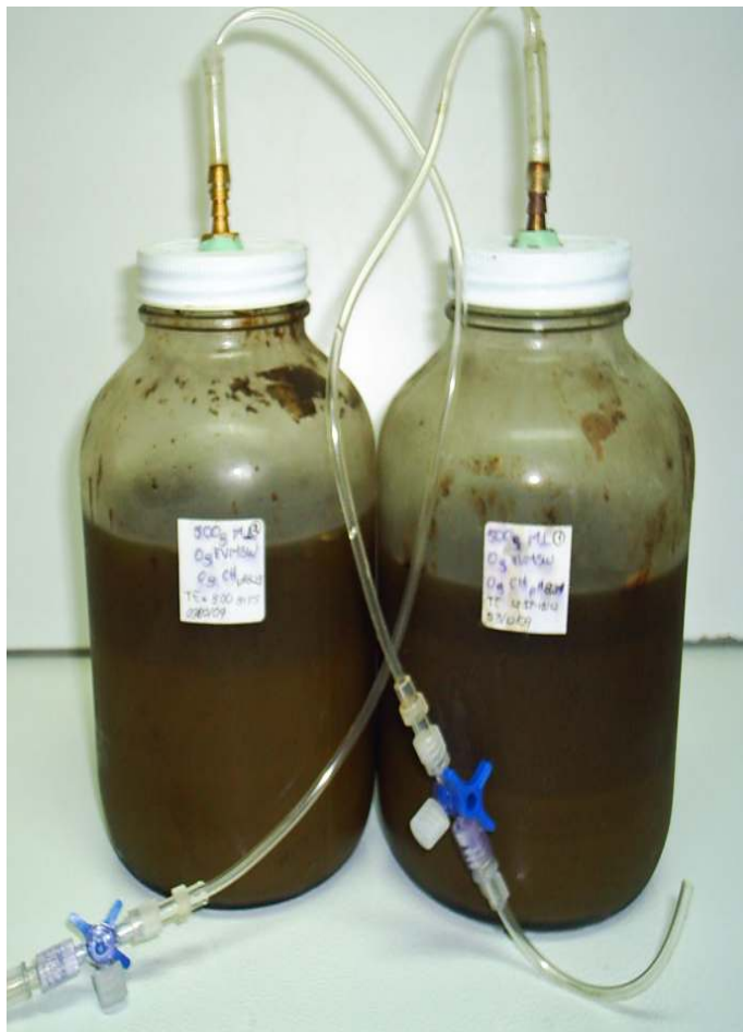
Fig. 1. Reactores utilizados para la producción de biohidrógeno.
