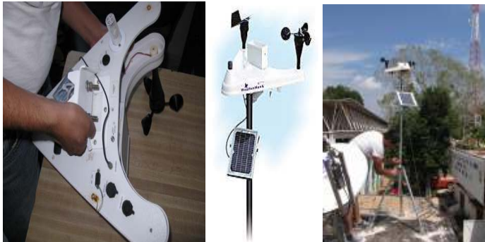
Fig. 2. Estación meteorológica WeatherHawk y panel solar.
