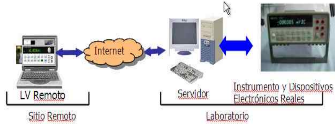
Fig 2. Esquema del Laboratorio Virtual Remoto de Electrónica CIBNOR-ITLP.
