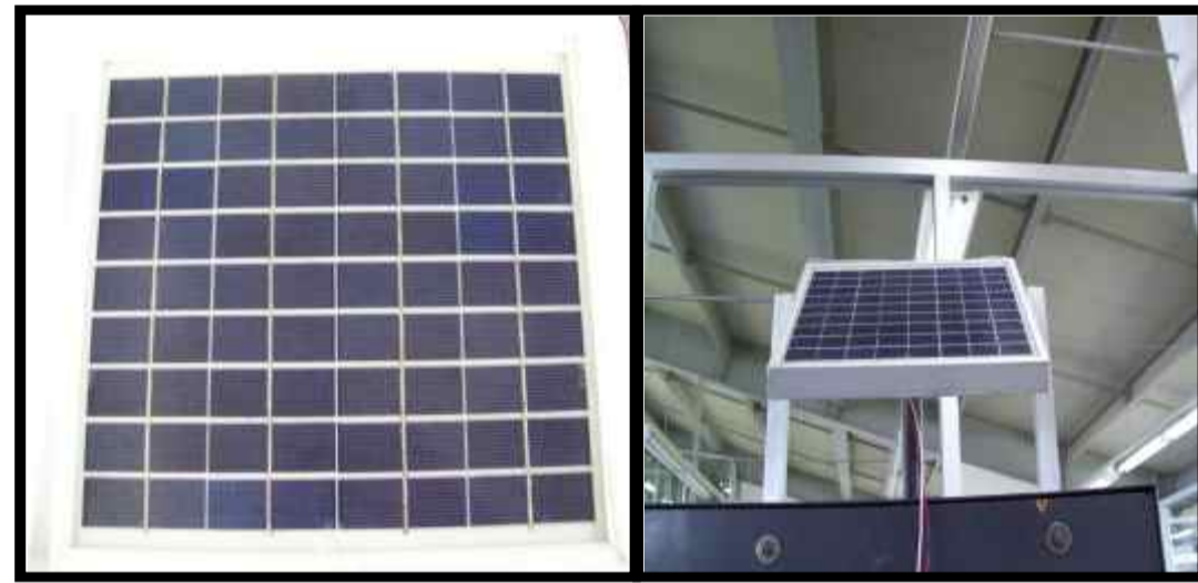
Fig. 4. Panel solar de 20 watts utilizado para aprovechar la energía del sol y alimentar la batería la cual proporciona la potencia necesaria para accionar la bomba y electroválvulas.
