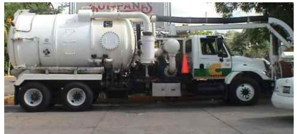
Fig. 4. Camión de desazolve en operación, con capacidad de reciclaje de agua de drenaje, mediante sistema de filtración y autonomía de suministro de agua.
