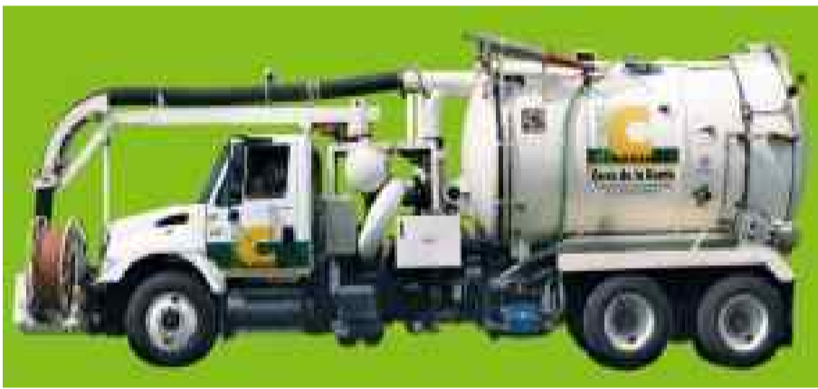
Fig. 1. Camión de desazolve de drenaje.
