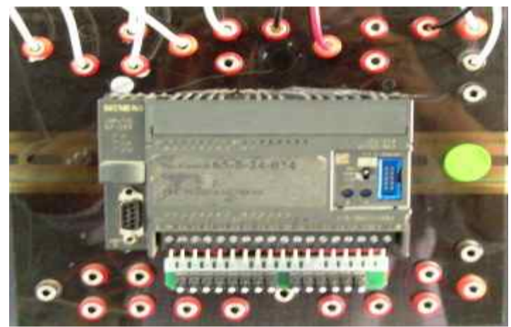
Fig. 3. Los PLC, Programmable Logic Controller en sus siglas en inglés, o Controlador de lógica programable, son dispositivos electrónicos muy usados en automatización industrial
