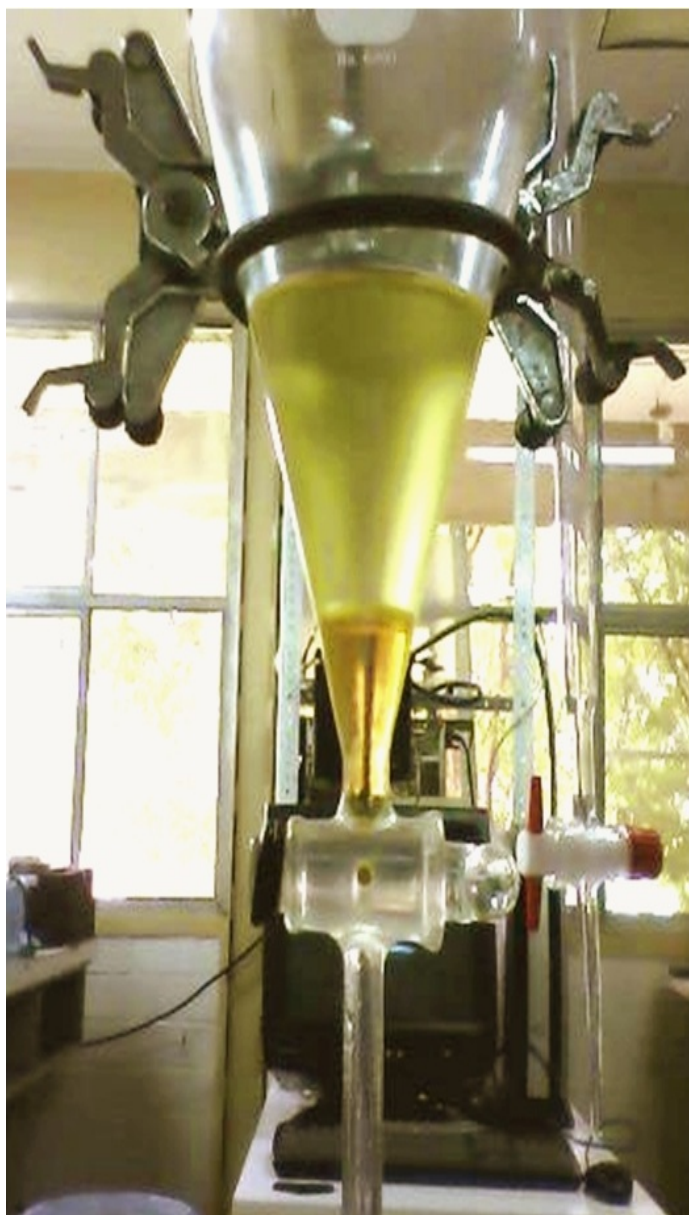
Figura 2. Aspecto del BD obtenido como un líquido de color amarillo claro y cristalino (fase superior), en la fase inferior se observa la glicerina con impurezas.
