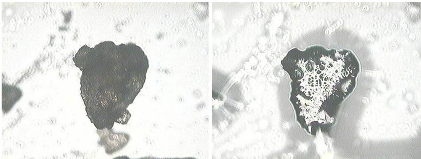
Figura. 3. Micrografía del material híbrido  $\text{SiO}_2$ /PAEOH seco (imagen izquierda) y con tolueno absorbido (imagen derecha); con un acercamiento de 10 veces
