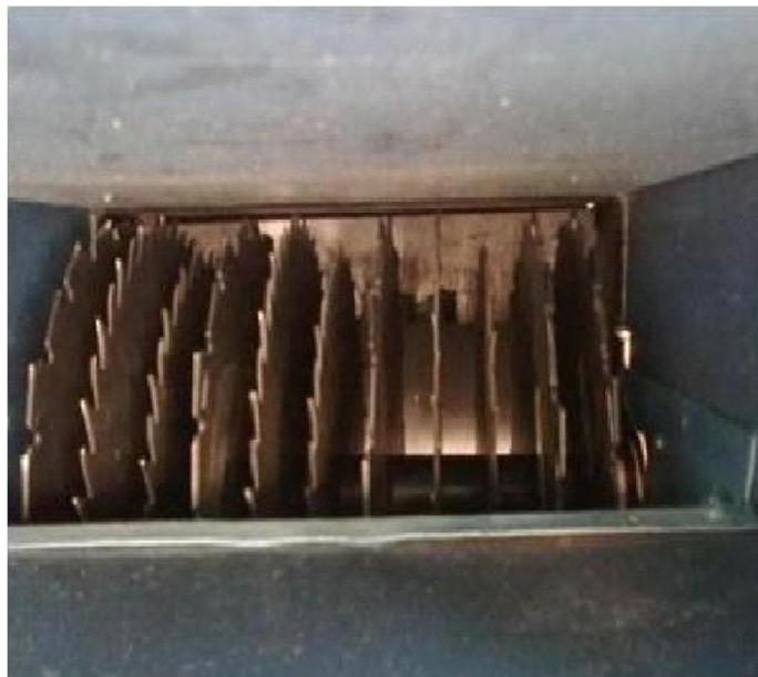
Figura 1. Ejemplos de sierras de disco utilizadas en la trituradora de PET reciclado.
