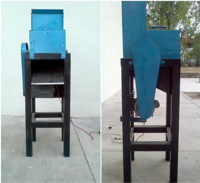
Figura 3. Prototipo de la trituradora de PET reciclado.
