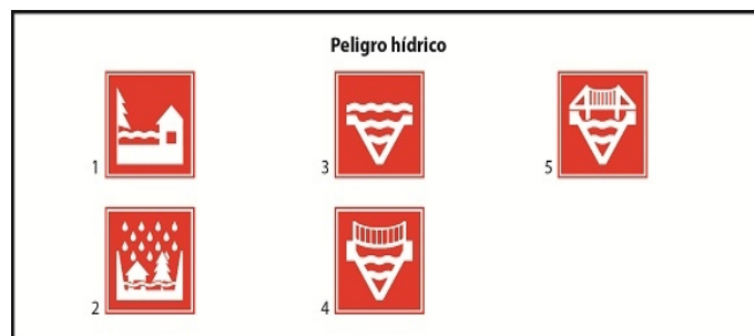
Figura 2.- Peligro hídrico: 1) Encharcamiento; 2) Inundación por escorrentía; 3) Inundación desborde de río; 4) Destrucción puente colgante por aumento del nivel del río; 5) Destrucción puente vehicular por río.
